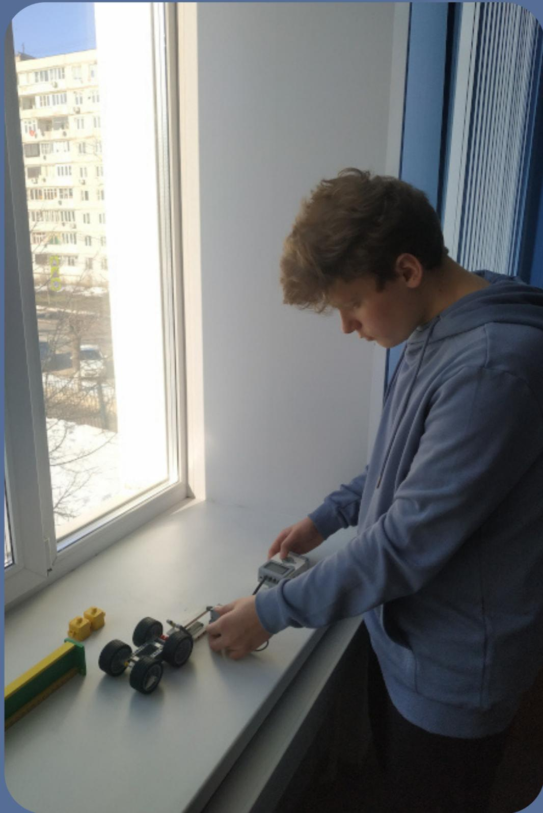
Собираем установку. Подбирали колеса, чтобы сила трения качения была достаточной для демонстрации эксперимента. Убедились, что толкатель исправен и выдает одинаковую силу удару.
